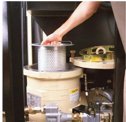
Il filtro separatore ha la linea di recupero olio incorporata; anche in questo caso è stata possibile l'eliminazione dei componenti di recupero olio un tempo installati sul coperchio del separatore stesso, inoltre il coperchio rotante, facilita l'operazione di sostituzione dell'elemento separatore. Il serbatoio del separatore ha due funzioni, rimuove il lubrificante dall'aria compressa e agisce come serbatoio del lubrificante.
