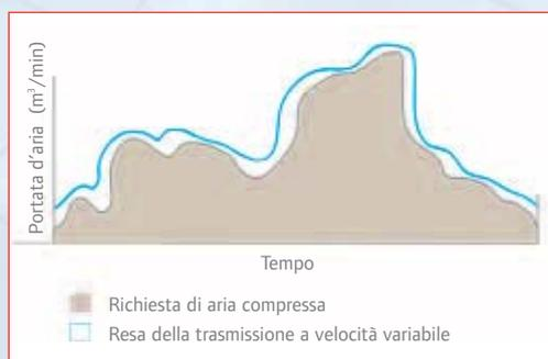
Il comando Nirvana viene attuato mediante una trasmissione a velocità variabile. La VSD del Nirvana 5.5-30 kW mantiene una pressione di impianto strettamente controllata, regolandone automaticamente la potenza per mantenere una resa ottimale dall'apparecchiatura di cui vi servite.
