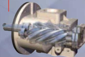
**Compressore rotativo a vite**
