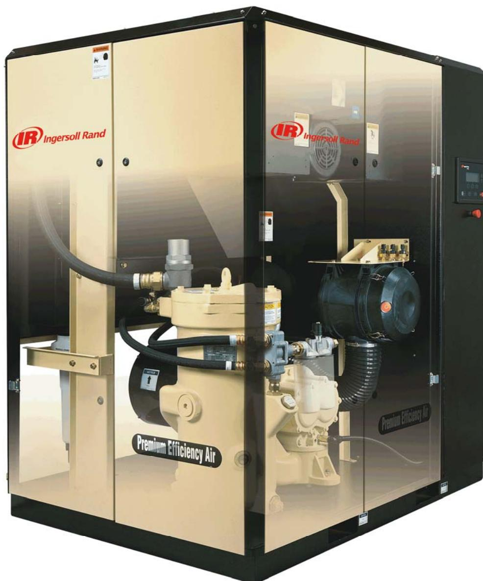
L'elettrocompressore monostadio rotativo a vite NIRVANA, è una centrale autonoma di aria compressa, raffreddata completamente ad aria, azionata da un motore elettrico di nuovissima concezione a magneti permanenti, completa in tutti i suoi componenti.
